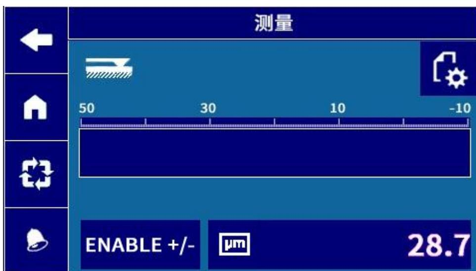
**窗口功能：**测量项目的测量值以数字形式显示和零位调整。
